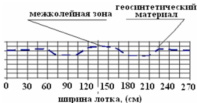
Рис. 2.1 Схема деформирования армированной дорожной одежды
